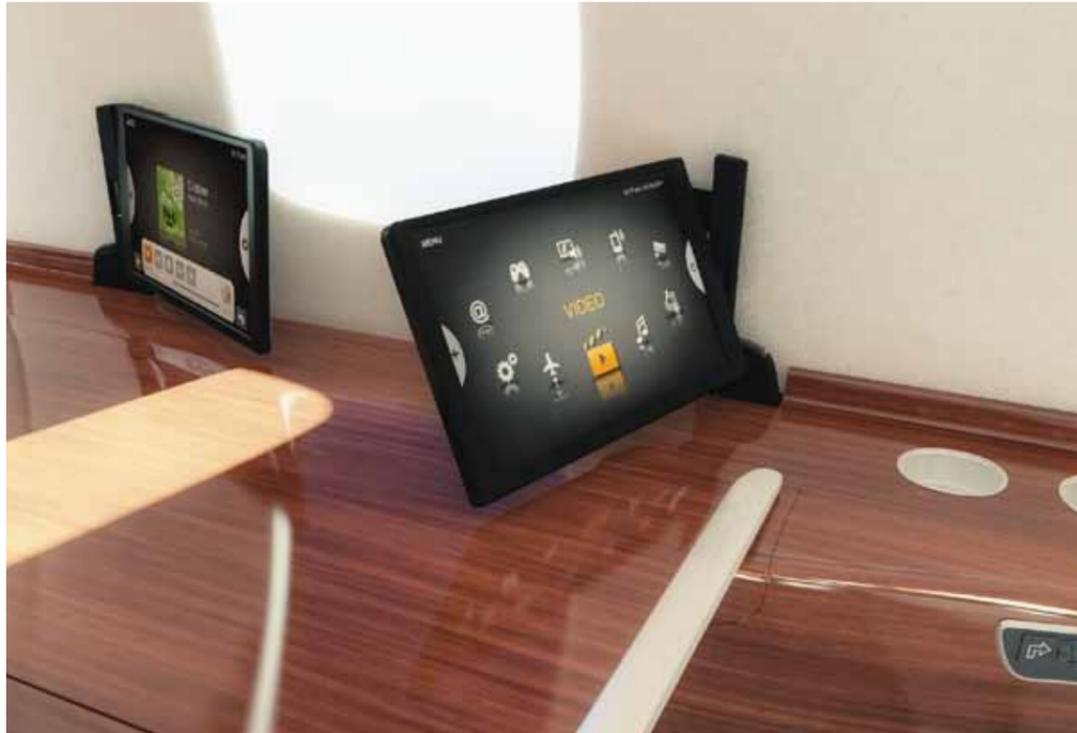
Das grafische User Interface des Entertainment- und Kabinensteuerungssystems nice HD in den damit serienmäßig ausgestatteten Bombardier Learjets 70/75 und 85. Die manuell ein- und ausklappbaren Displays lassen sich nicht nur per Smartphone oder Touch-Bedienung, sondern auch einfach mit dem in die Tischoberfläche eingelassenen Scrollrad steuern
